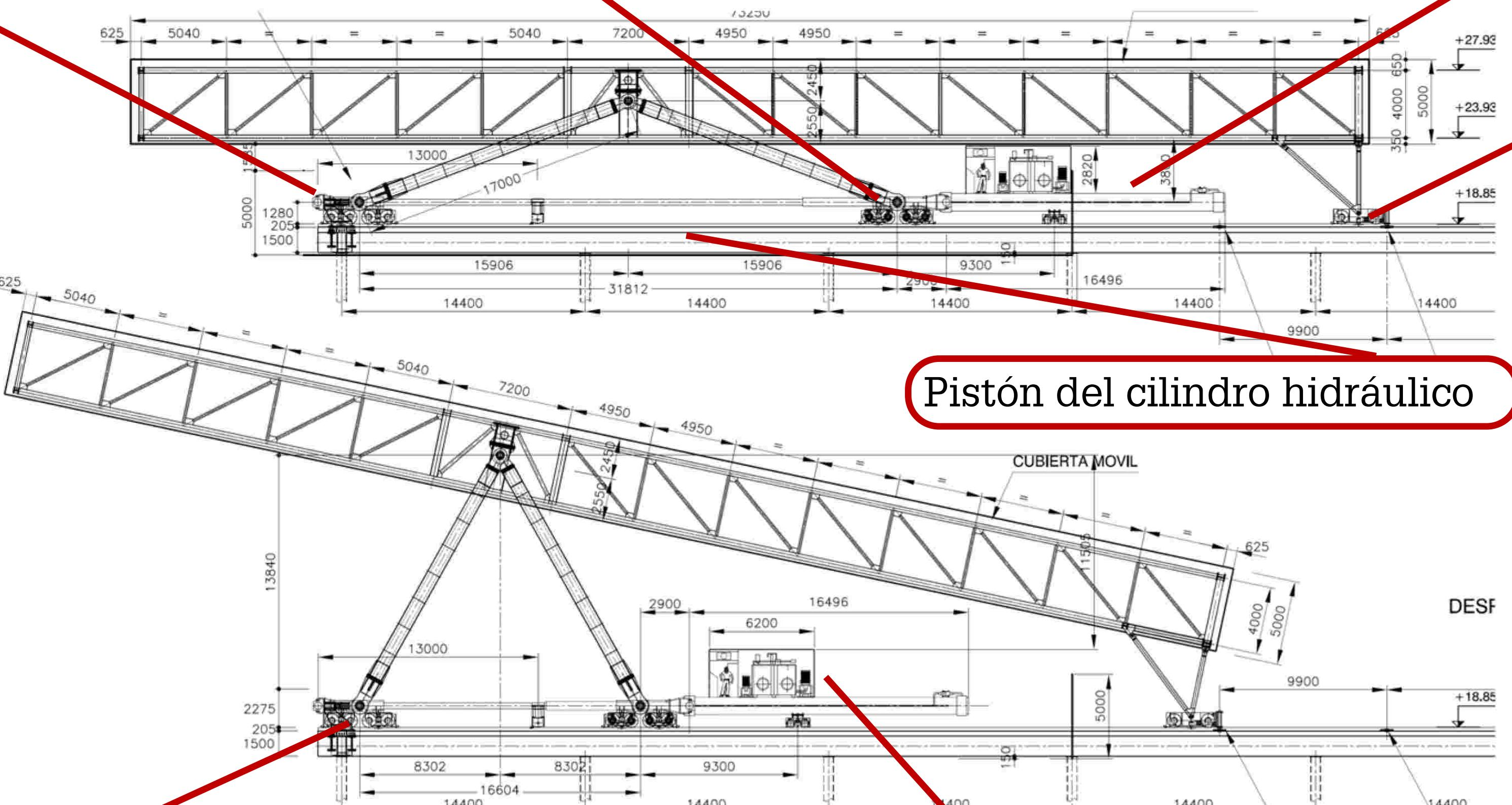
Conexión de mecanismos y estructura de cubierta móvil 1.
